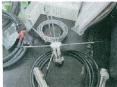
航空機接近検知識別装置センサー
